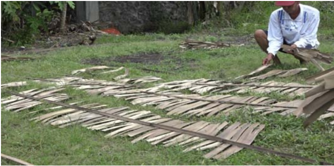
Gambar 4.6 Proses pengeringan tahap II setelah daun lontar direbus dalam beberapa jam.
