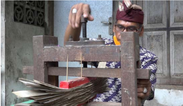
Gambar 4.7 Proses blagbag yaitu menjepit lontar dengan sekuat-kuatnya
