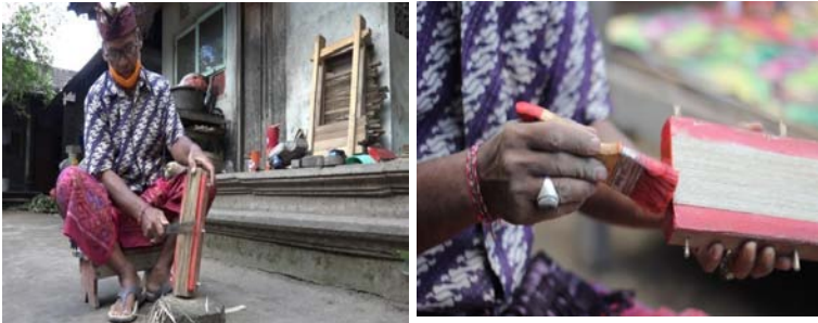
Gambar 4.9 Kiri proses nyerut, dan kanan proses pemberi warna (enci) pada tepian lontar
