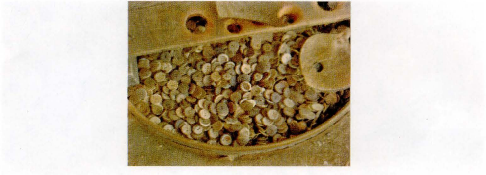
Foto 31. Kancing baju bathok yang siap diampelas
